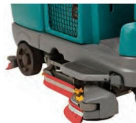
**Обеспечьте высокую эффективность** забора разлитой воды в самых труднодоступных зонах с телескопической вакуумной трубкой
